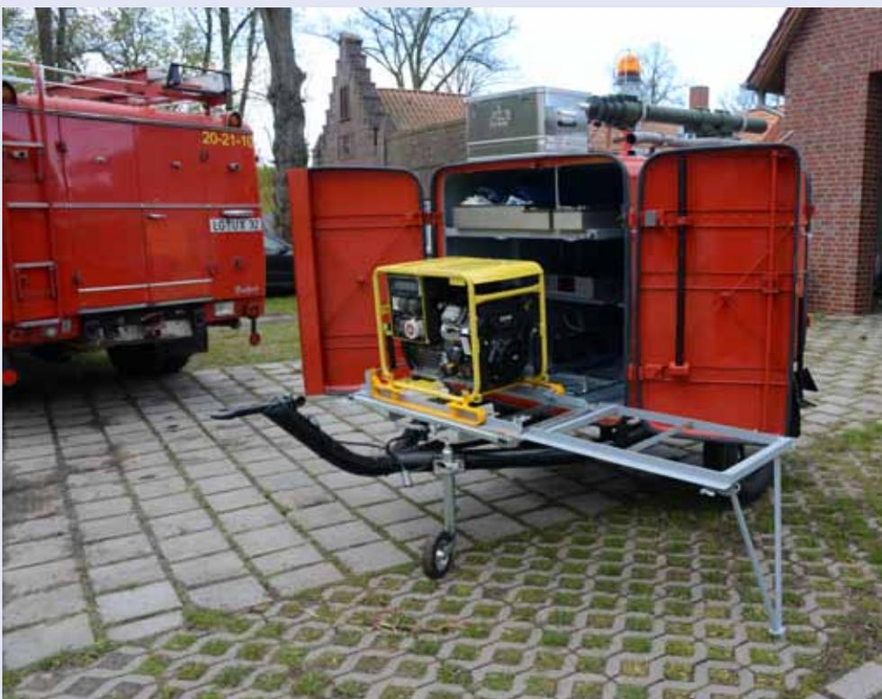
Die Feuerwehr baute einen neuen Stromerzeuger, diverse Halterungen und Ablagen für Geräte in den Anhänger ein. So wurde die Umfeldbeleuchtung des Anhängers verbessert, das Dach begehbar gestaltet und ein Licht-Kurbelmast angebaut.
