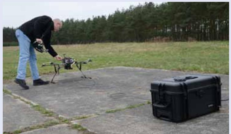
Eine Drohne mit externer Stromverbindung für einen mehrstündigen Einsatz stellte die Firma Copting vor.
