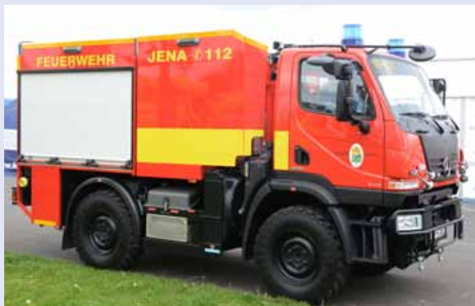
TLF 2000 Unimog U 20 Bluetec 5, Radstand: 2.700 mm, Aufbau: Empl Fire-Fighter ALU-TEXH Sandwich-Paneele, Löschwassertank 2.000 l, Schaummitteltank 120 l, FPN: Empl 10-2000
