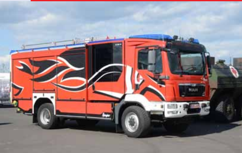
HLF 20 MAN TGM 13.290 4x4, Aufbau: Ziegler-ALPAS Z-Cab mit Z-Protec, Löschwasser 2.000 l, Schaummitteltank 120 l, Lichtmast LED
