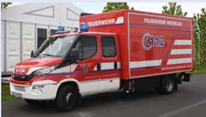
GW-L IVECO Daily 70-180, Differenzialsperre an der Hinterachse, zGM: 7.200 kg, Aufbau: Junghanns mit Ladebordwand MBB Palfinger C 1000 L, Hubkraft 1.000 kg
