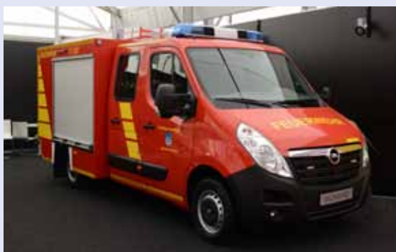
TSF Opel Movano L2H1 3,5 2.3 Cdti, Leistung: 96 kW / 130 PS, 6-Gang-Schaltgetriebe, Aufbau: Meinicke
