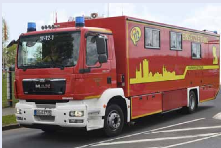
ELW 2 MAN TGM 15.250 4x2 BL Leistung: 184 kW / 250 PS Gesamtgewicht: 15.000 kg Lange/Breite/Höhe: 10,46 m / 2,5 m / 3,38 m Ausbau: Gimaex Baujahr: 2016 Feuerwehr Göttingen
