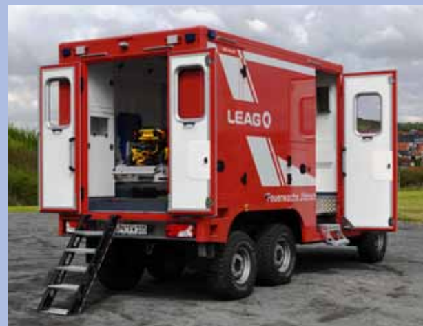
RTW Mercedes-Benz Sprinter 6x6 Oberaigner, z.GM: 7.000 kg, Aufbau: Binz, Werkfeuerwehr Vattenfall
