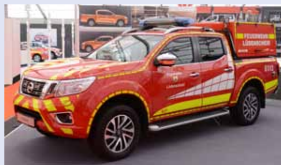
MZF Nissan Navara Double Cab 4x4 2.3 dCi Motor Automatic, Ausbau: Holzapfel mit Wechselcontaineraufbau, Feuerwehr Lüdenscheid
