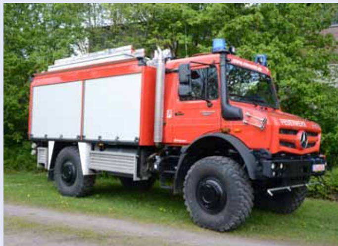
TLF 3000 Unimog 5023 BlueTec 6 4x4, Radstand: 3.850 mm, z.GM: 14.000 kg, Aufbau: Schlingmann VARUS mit Schaumtank, Kabine mit Dachluke, Dachwerfer
