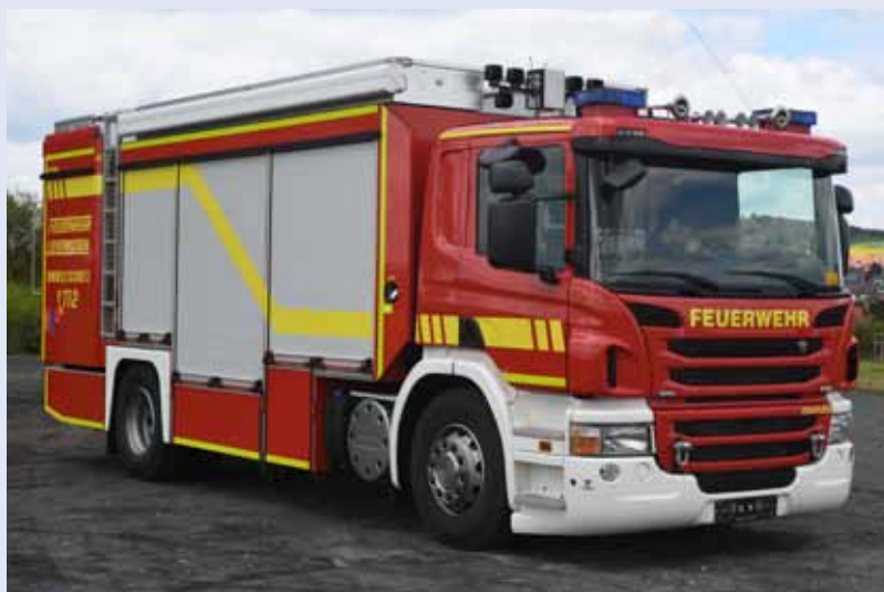
GW-G Sancia P 310 DB 4x2 MNA, Radstand: 4.200 mm, Leistung: 228 kW / 290 PS Euro 5, z.GM: 18.600 kg, Aufbau: Gimaex, Alu-Profilsystem Tiefzug, begehbare Dach, mobiler Stromerzeuger 14 kVA, Bergefaß, Ladebordwand 1.500 kg, Kastenmarkise, Lichtmast 6x50 W LED
