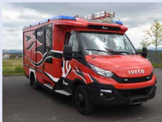
MLF IVECO Daily 70C170, Aufbau: Ziegler-Alpas Z-Cab, Löschwasser 800 l, zGM 7.200 kg
