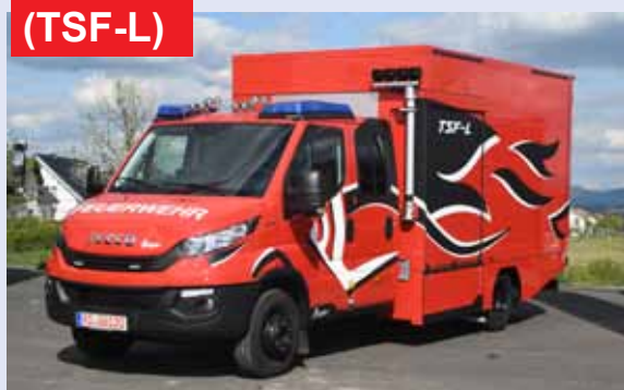
TSF-L IVECO Daily 70/180, Aufbau: Ziegler mit Ladebordwand und die Möglichkeit fünf Rollcontainer heckseitig zu laden, zGM: 7.200 kg
