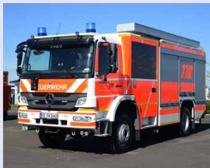
LF 20 Mercedes-Benz Atego 1329 AF 4x4, Aufbau: Walser, 4 x PA in den Sitzen der Mannschaftskabine, Löschwassertank 2.000 l, Schaummitteltank 120 l, Lichtmast LED, zGM: 14.500 kg
