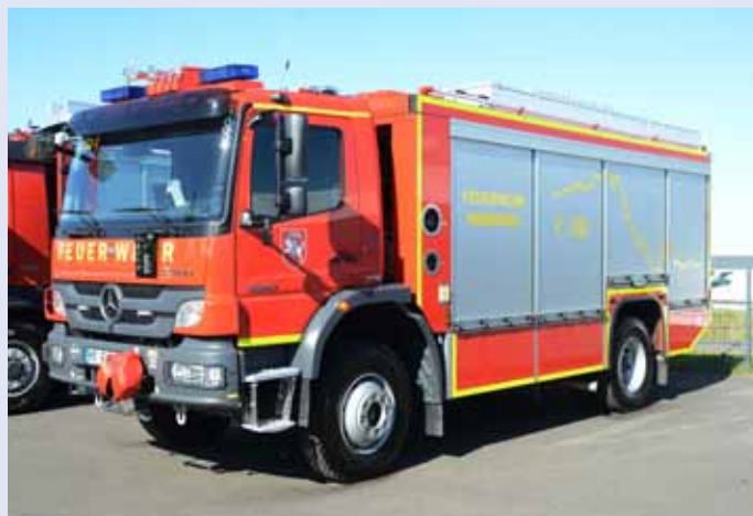
RW Mercedes-Benz Atego 1629 AF 4x4, z.GM: 16.000 kg, Aufbau: Walsler Alu Line, Stromgenerator 20 kVA, Winde Treibmatic TR 030/6, Lichtmast 6x50 W LED, mobiler Stromerzeuger, Motor-Schlauchboot
