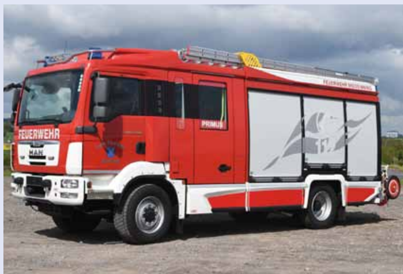
(H)LF 20 MAN TGM 13.290 4x4, Radstand: 4.200 mm, Aufbau: Empl-Primus, Kabine: Mod-Tech II, Aufbau: Fire-Fighter Alu-Tech Sandwich-Panels, Löschwassertank 2.000 l, Schaummitteltank 120 l, FPN Empl 10-3000, Lichtmast Function Light 8 x LED
