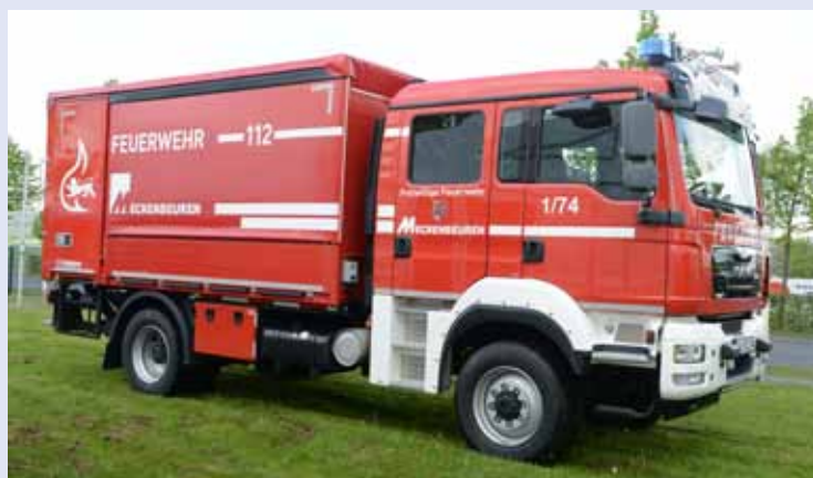
GW-L MAN TGM 15.290 BB, Aufbau: Junghanns mit Ladebordwand, Feuerwehr Meckenbeuren
