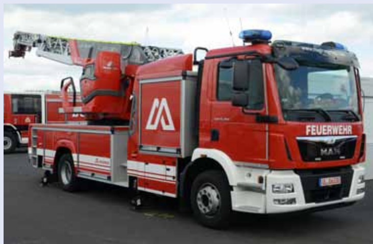
DLK 23-12 GL MAN TGM 15.290 4x2 BL, Aufbau: Magirus M 32 GL
