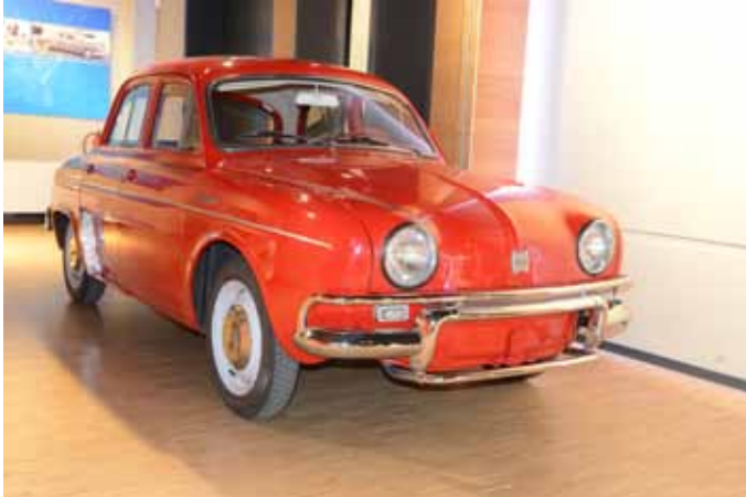
Der Henney Kilowatt wurde auf der Basis eines Renault Dauphin gefertigt
