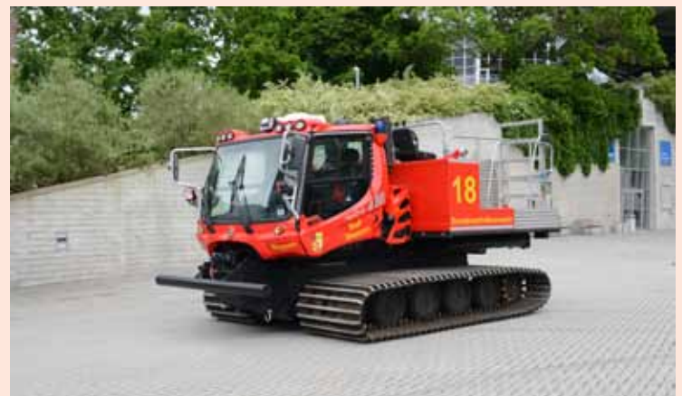
Löschraupe mit der Basis eines Pisten-Bullis 400 von Käsbohrer. Das Fahrzeug verfügt über einen Wassertank von 3.200 l und bringt einen Bodendruck von 140 g/cm 2 auf den Moorboden.
