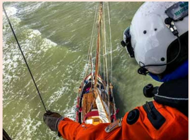
Northern Rescue 01 (NHC) über dem Havaristen. Ein Notfallsanitäter ließ sich per Winde auf dem Segler absetzen und holte den Segler im sogenannten Doppelwischverfahren von Bord.
