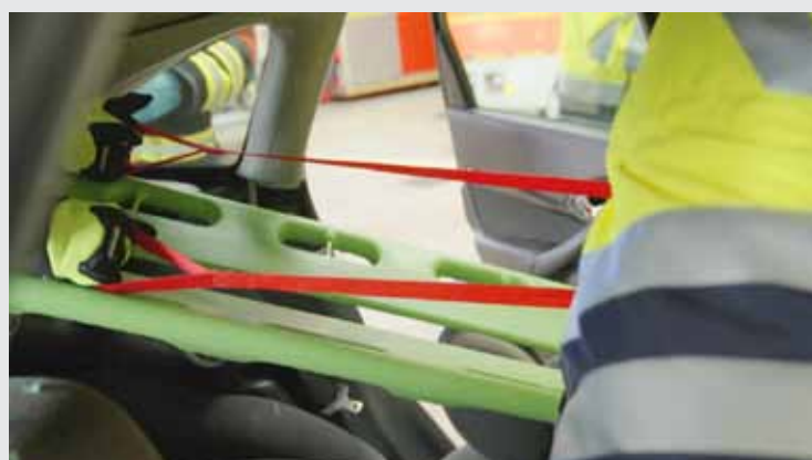
Über die an der Weste befestigten Gurte kann der Patient schnell und sicher auf ein Spineboard gezogen werden.
