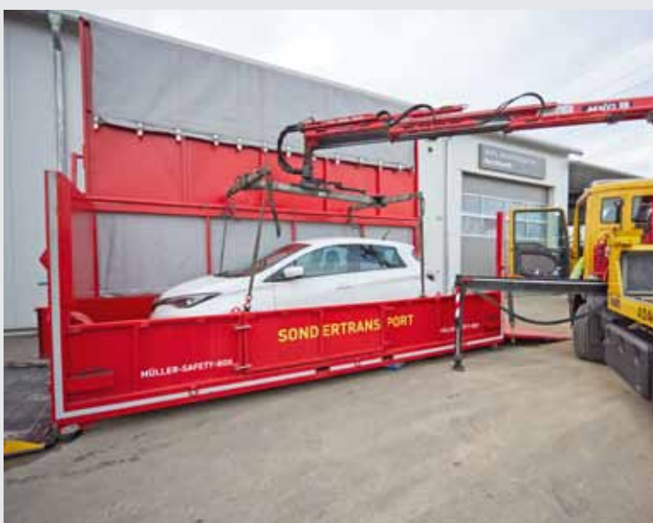
Ein havariertes E-Fahrzeug wird per Kran in den Müller Safety Trailer verladen.
