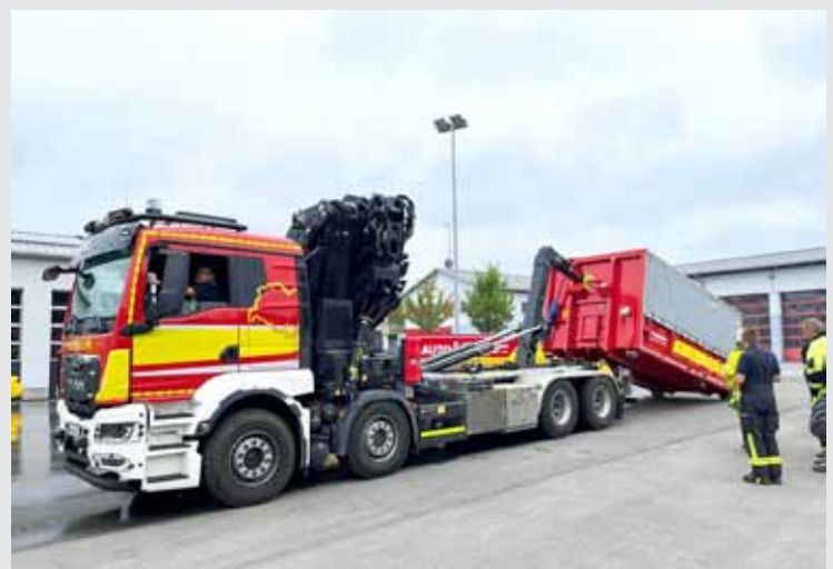
Ein Wechsellader sattelt den AB Hochvolt (Müller Safety Box) auf.
