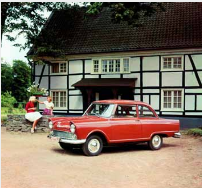
DKW Junior von 1959. Der Kleinwagen mit Zweitakter-Motor, Lenkradschaltung und viel Stauraum im Kofferraum.
