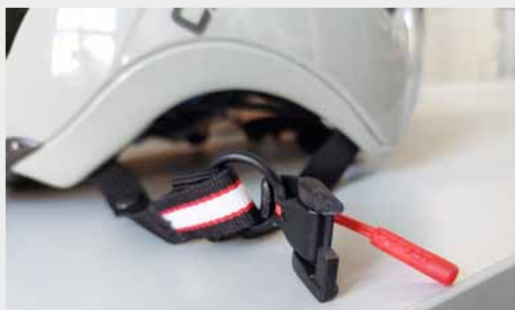
ADAC-Test Fahrradhelme (2024): Gebrochenes Gurtschloss am Helm von Casco.
