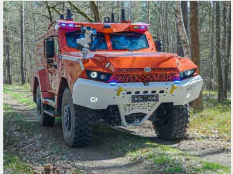
Sondergeschütztes Fahrzeug zur Steuerung und Erkundung (TRITON) Funktion: ballistisch geschütztes Einsatzfahrzeug zur Fernsteuerung der ferngeführten, landgebundenen Maschinen sowie zur Detektion und Messung von chemischen und radioaktiven Stoffen in besonderen Gefahrenbereichen Abmaße (LxBxH): 6.250 x 2.550 x 2.800 mm Gesamtmasse: 18.000 kg Menge: 1 Stück Auftragnehmer: EXCALIBUR ARMY spol. s.r.o. (Tschechien)
