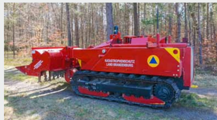
Unbemanntes Fahrzeug für Räum- und Lösch Tätigkeiten (MVF-5) Funktion: ferngeführte, landgebundene Maschine für Brandbekämpfung und Beräumung von Hindernissen in besonderen Gefahrenbereichen Abmaße (LxBxH): 5.750 x 2.315 x 2.320 mm Gesamtmasse: 16.000 kg Menge: 1 Stück Auftragnehmer: DOK-ING Ltd. (Kroatien)
