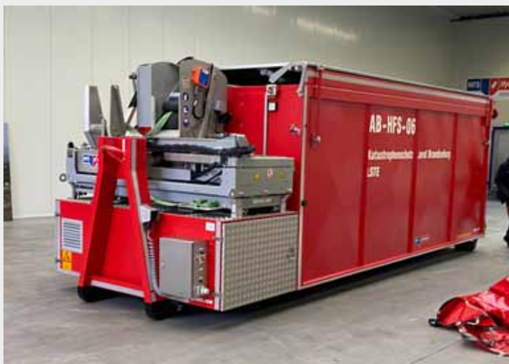
Abrollbehälter F-Schlauch HFS (AB F-Schlauch) Funktion: Abrollbehälter zum Transport und Auslegen von 3.800 m F-Schlauch zur Löschwasserversorgung über lange Wegstrecken; Ergänzung der fünf vorhandenen Hochleistungsfördersysteme in Brandenburg Abmaße (LxBxH): 6.900 x 2.500 x 2.480 mm Gesamtmasse: 13.900 kg Menge: 1 Stück Auftragnehmer: Hytrans Systems B.V. (Niederlande)
