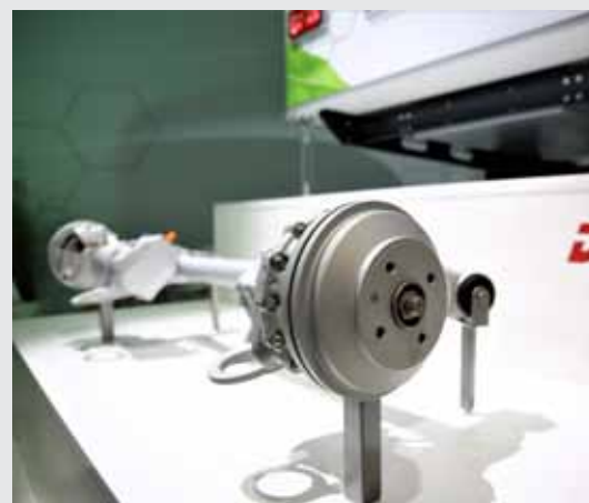
Die Achse des Wohnanhängers mit den beiden Elektromotoren an den Radhalterungen.
