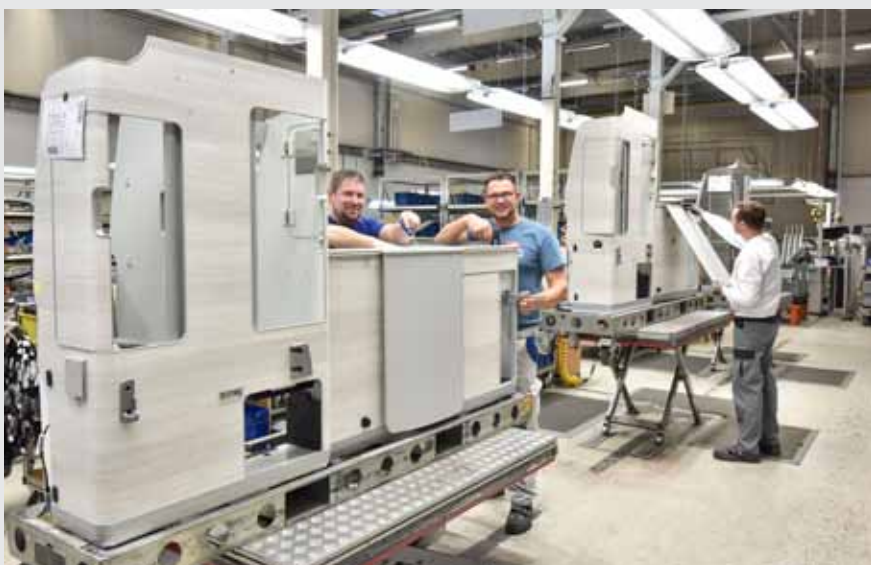
Hier wird der Küchenblock gefertigt, der linksseitig in das Fahrzeug eingeschoben und montiert wird. Dieser passgenaue, hochwertige Küchenblock stellt eines der Herzstücke des Californias dar.
