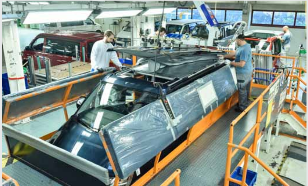
In Handarbeit oder Handwerksarbeit wird im Werk Hannover-Limmer das Aufstelldach in den California eingebaut.
