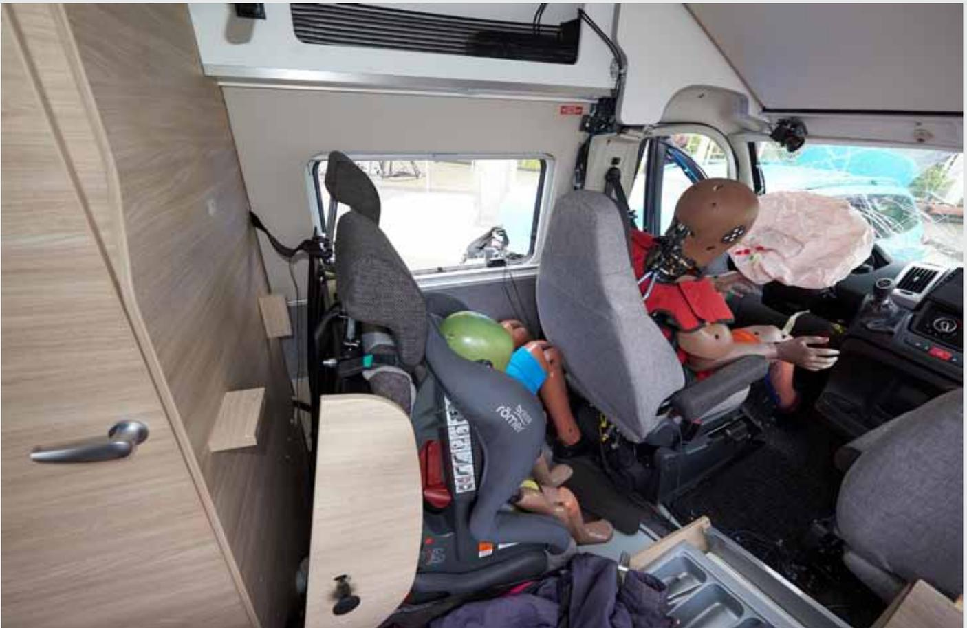
Um die Sicherheit zu erhöhen, sei es hilfreich, besonders schwere Gepäckstücke ganz nach unten und mit Spanngurten zu sichern und schwere Ladung im abgetrennten Kofferraum unterzubringen. In der Küche sollte leichtes Kunststoff-Geschirr zum Einsatz
