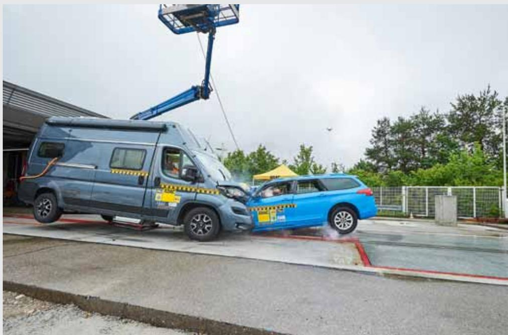
Der ADAC folgert daraus, dass Hersteller von Wohnmobilen, egal ob auf Basis eines Pkw oder eines Nutzfahrzeugs, die Fahrzeugfront so konzipieren müssen, dass die Energie des Aufpralls in der Knautschzone abgebaut wird, die Fahrgastzelle muss als Überlebensraum stabil bleiben, damit die Insassen bestmöglich geschützt sind.
